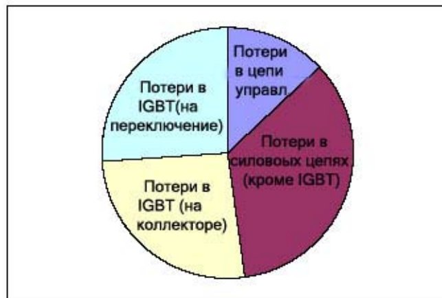
Рисунок 6 Составляющие общих потерь в инверторе
